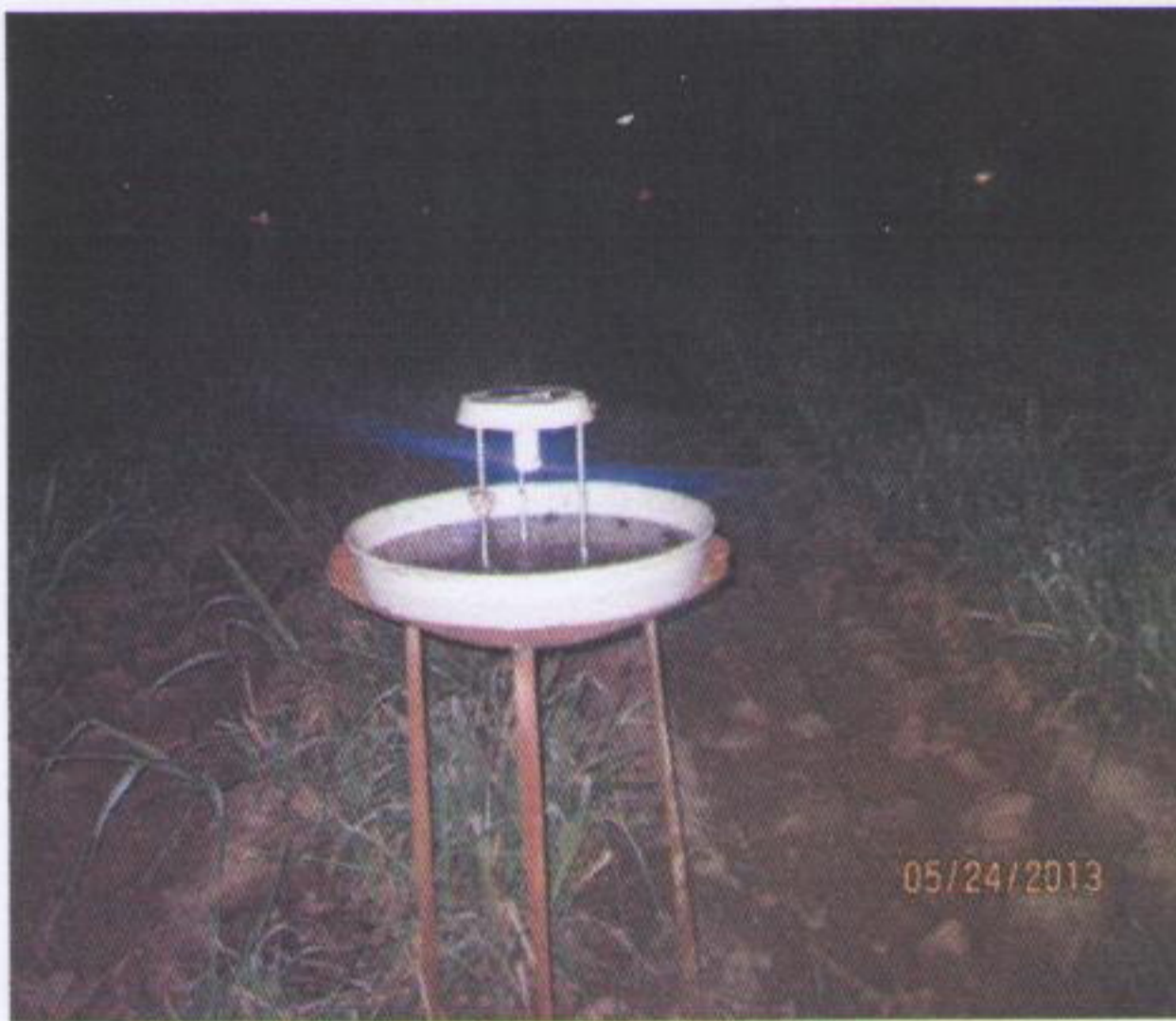
شکل ۵- تله نوری نصب شده در مزرعه نیشکر
